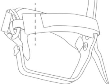
EDELRID Baumsteigeisen entsprechend der Norm ANSI F887-13 für den Gebrauch bei Baumpflegearbeiten und Installationsarbeiten an Holzmasten, Pfählen und Bäumen als Aufstieghilfe. Dieses Produkt ist nicht für den Einsatz im Bergsport geeignet!
